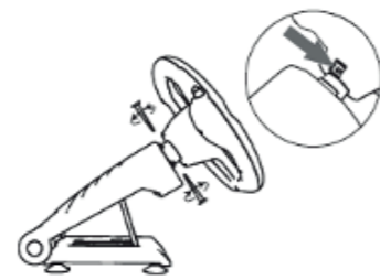
Assicurare le viti fornite come illustrato con gli strumenti inclusi. Non stringere eccessivamente.
