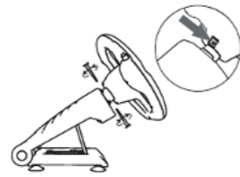
Aperte os parafusos fornecidos conforme ilustrado, utilizando a ferramenta incluída, sem apertar demais
